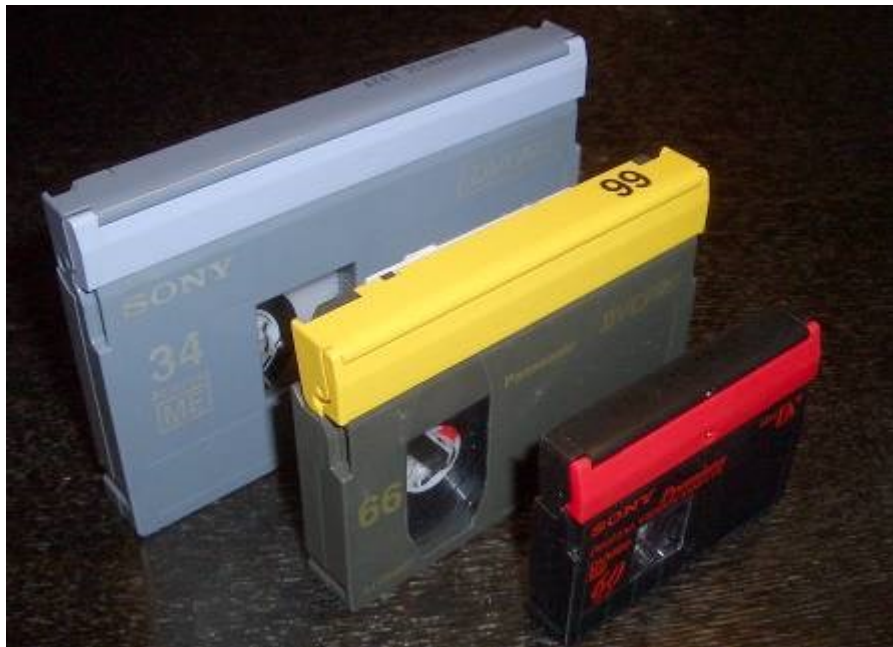
Odnosi gabarita formata BETACAM / DVCPRO / miniDV
