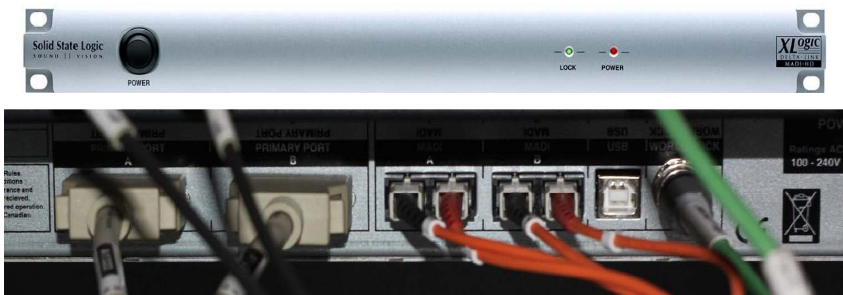
Slika 34. Xlogic Delta MADI HD. Prikaz prednjeg i zadnjeg panela
