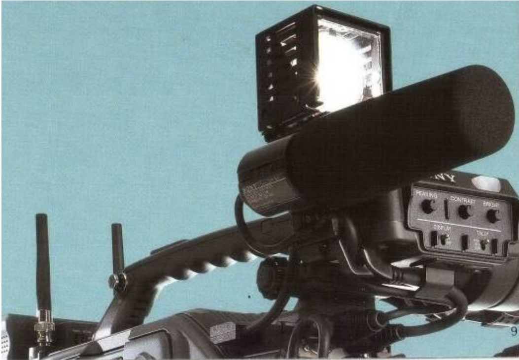
Rasvetno telo pozicionirano na kamkorderu
